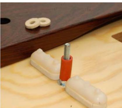
3. Nun die Ersatzteile in umgekehrter Reihenfolge anbringen. **Wichtig:** Die Schraubenmutter nicht zu fest ziehen. Die Klangplatte muss sowohl in Längs- und Querrichtung als auch nach oben etwas Spiel besitzen um optimal schwingen zu können.
