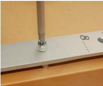
2. Mit einem Bohrer (am besten  $\text{\O} 4,2 \text{ mm}$ ) wie gezeigt mit der Hand die Reste des Auflagegummis ausbohren. Evtl. verbleibenden Rest mit Pinzette entfernen.
